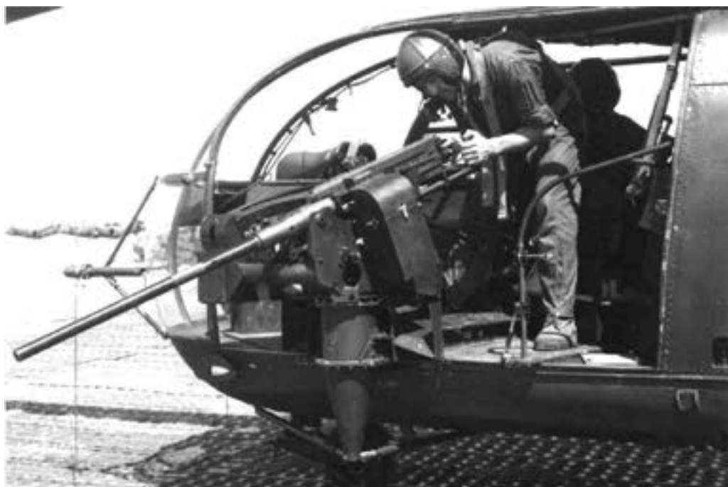
L'Alouette III équipée du canon de 20 mm
