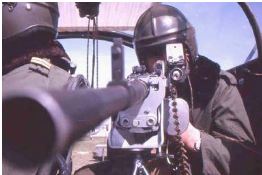
L'Alouette II équipée de la mitrailleuse AA-2 et le tireur installé en place arrière
