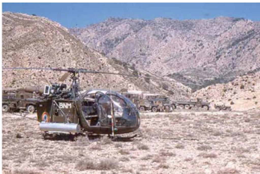
L'Alouette II équipée de paniers de roquettes MATRA LR 361 avec 36 roquettes de 37 mm
