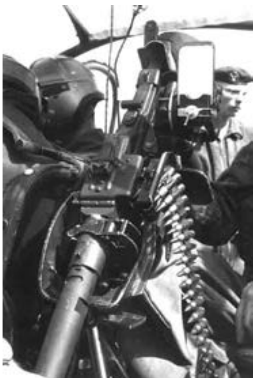
▼ La mitrailleuse AA-52 (7,62mm) montée sur l'Alouette III
