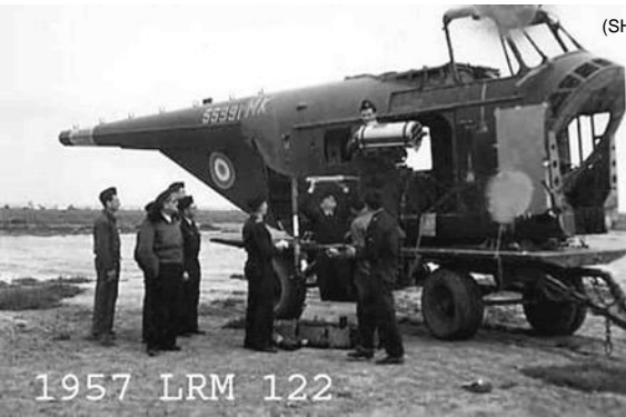
Essais au sol de roquettes T-10 et de panier Matra avec une carcasse de H-19
