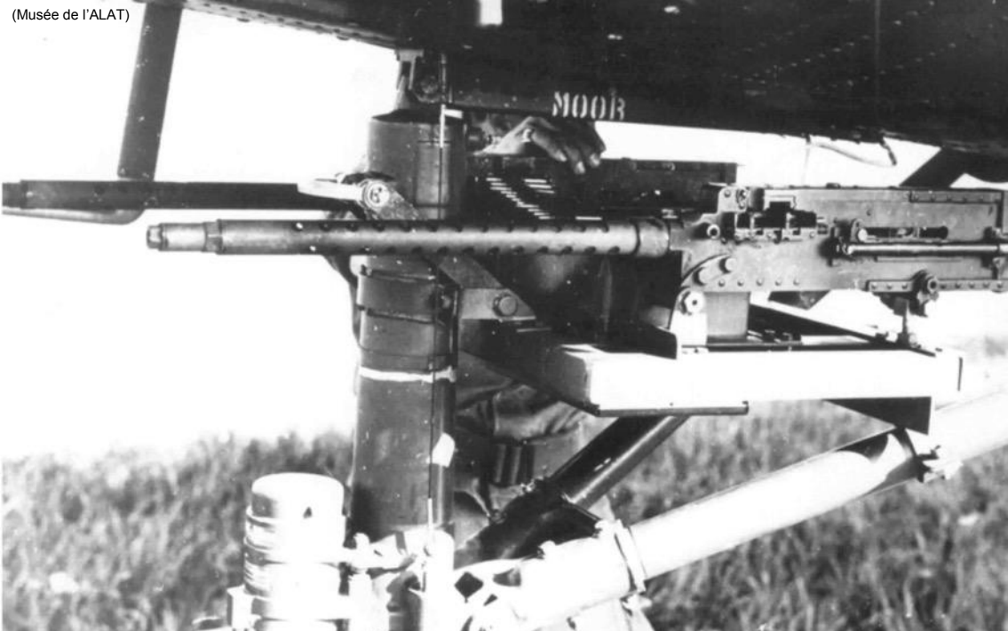
Montage des mitrailleuses de 30 (7,62 mm) sur la jambe de train avant d'un H-21
