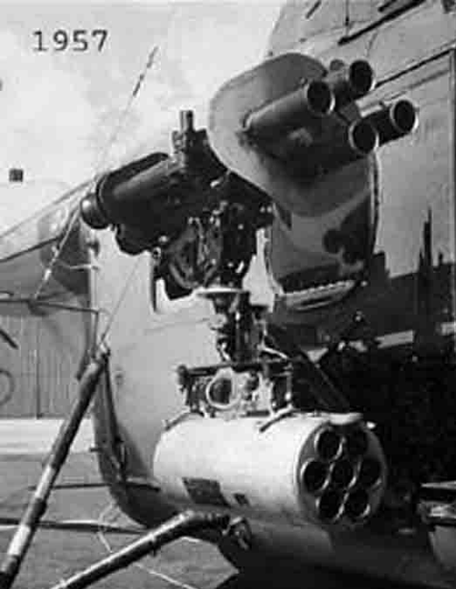
Orgue LRAC sur Corsaire 2 ème version et panier Matra LRM 122 pour projectiles SNEB de 68 mm
