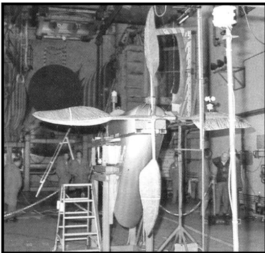
Hélice de l'AVION N°III de Clément ADER au banc T1, entraînée par un moteur électrique.
