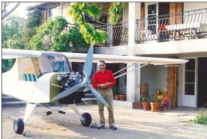
Le fuselage du cockpit jusqu'à la queue de l'ULM était en tubes d'acier d'aviation soudés par soudure TIG. Chaque tube se devait d'être étanche afin d'éviter la corrosion interne. Lorsqu'ils soupçonnaient l'existence d'une fuite ils mettaient tout le reste en pause afin de la trouver et de la ressouder.
