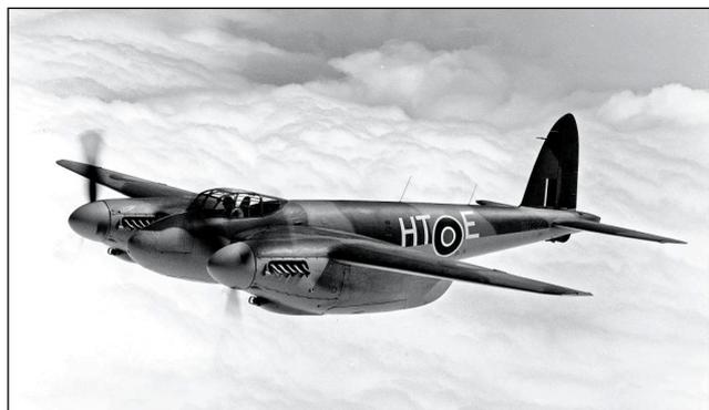
Sa structure à base de bouleau du Canada et de balsa, technique d'avant-garde, réduisait le recours aux matériaux traditionnels.
