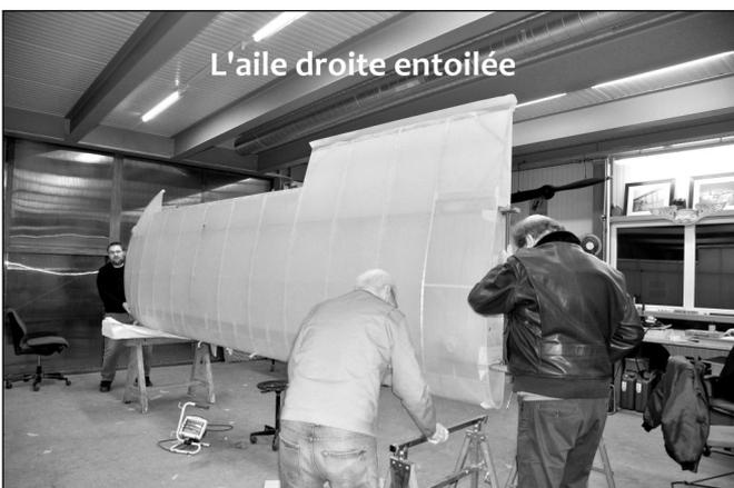
Une fois le squelette de l'avion et les ailes restaurés mais encore nus, une mise en croix préalable a eu lieu pour régler dièdre et incidence. Puis tout désassemblé pour l'entoilage.
