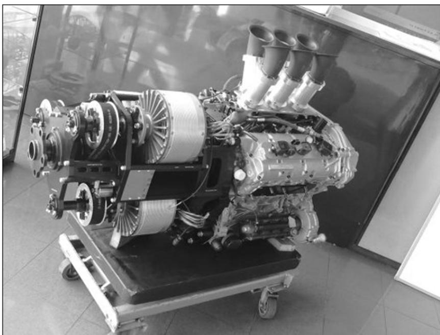
Volt Aero motorisation arrière avec un moteur thermique et trois moteurs électriques
