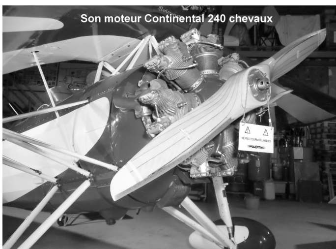
Moteur Hispano Suiza 9 cylindres 240 chevaux
