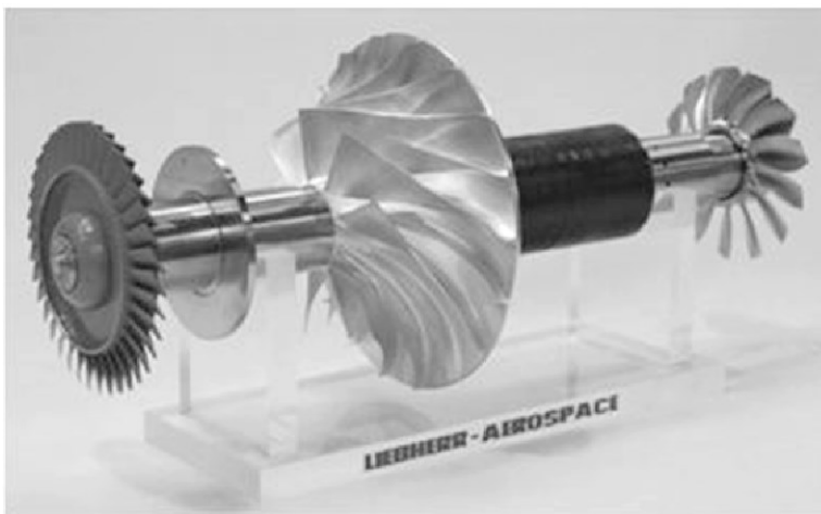
Mobile de la turbomachine motorisée (conditionnement d'air électrique)
