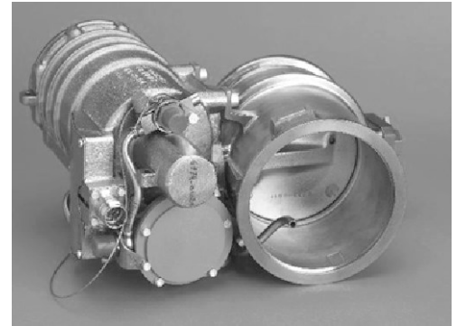
Vanne de régulation de pression (PRV)
