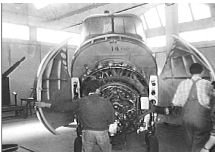
Ouverture de la partie moteur du H19 de l'E.N.P.A.
