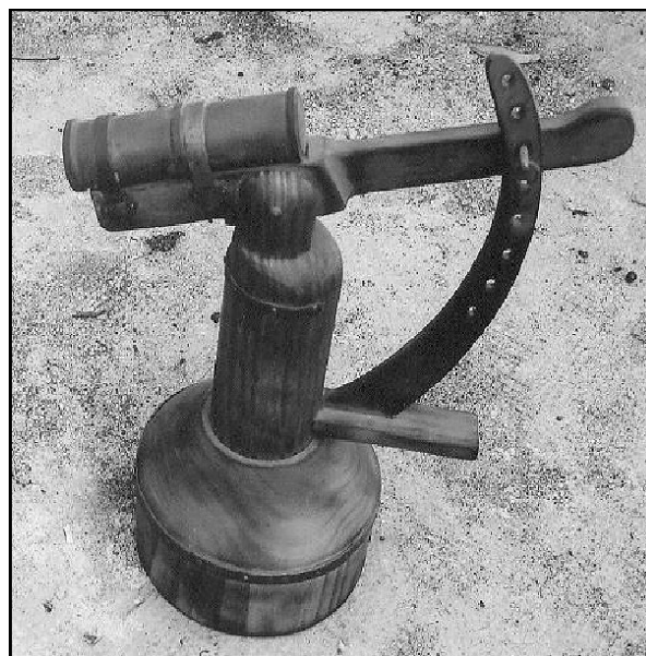
Canon de rempart de 1392 Calibre : 5 cm Poids : 45 Kg L'affût (partie bois) permet le pointage en hauteur et en direction. Défense de château fort.
