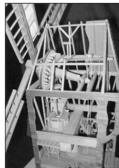
Mécanisme de manœuvre des sacs.
