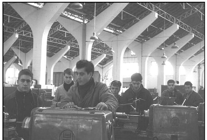
L'exercice consistait à usiner un cylindre de métal brut, inséré dans les **mors du mandrin** ou bien adapté à un **toc**, autre système d'attache entre la pièce et le mouvement. A l'autre extrémité du
