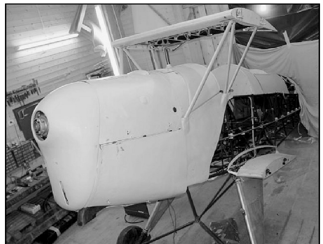
La « cabane » et fixations d'ailes, le moteur est monté.
