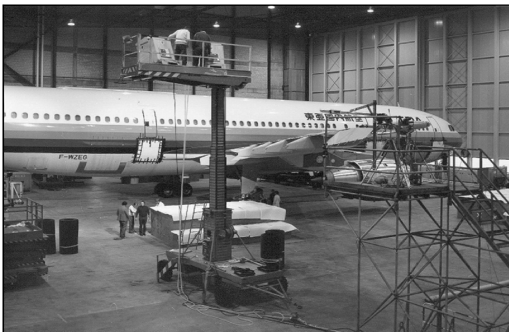
Préparation de l'avion et des installations au sol, projecteurs et caméras
