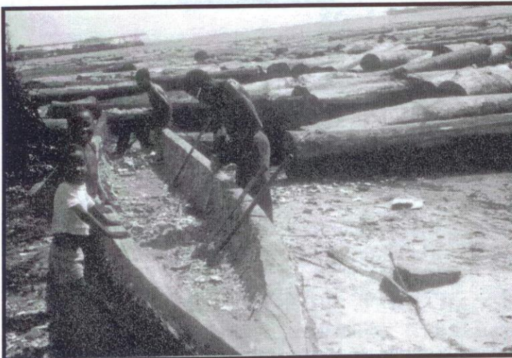
Construction d'une pirogue dans une bille d'Okoumé.
