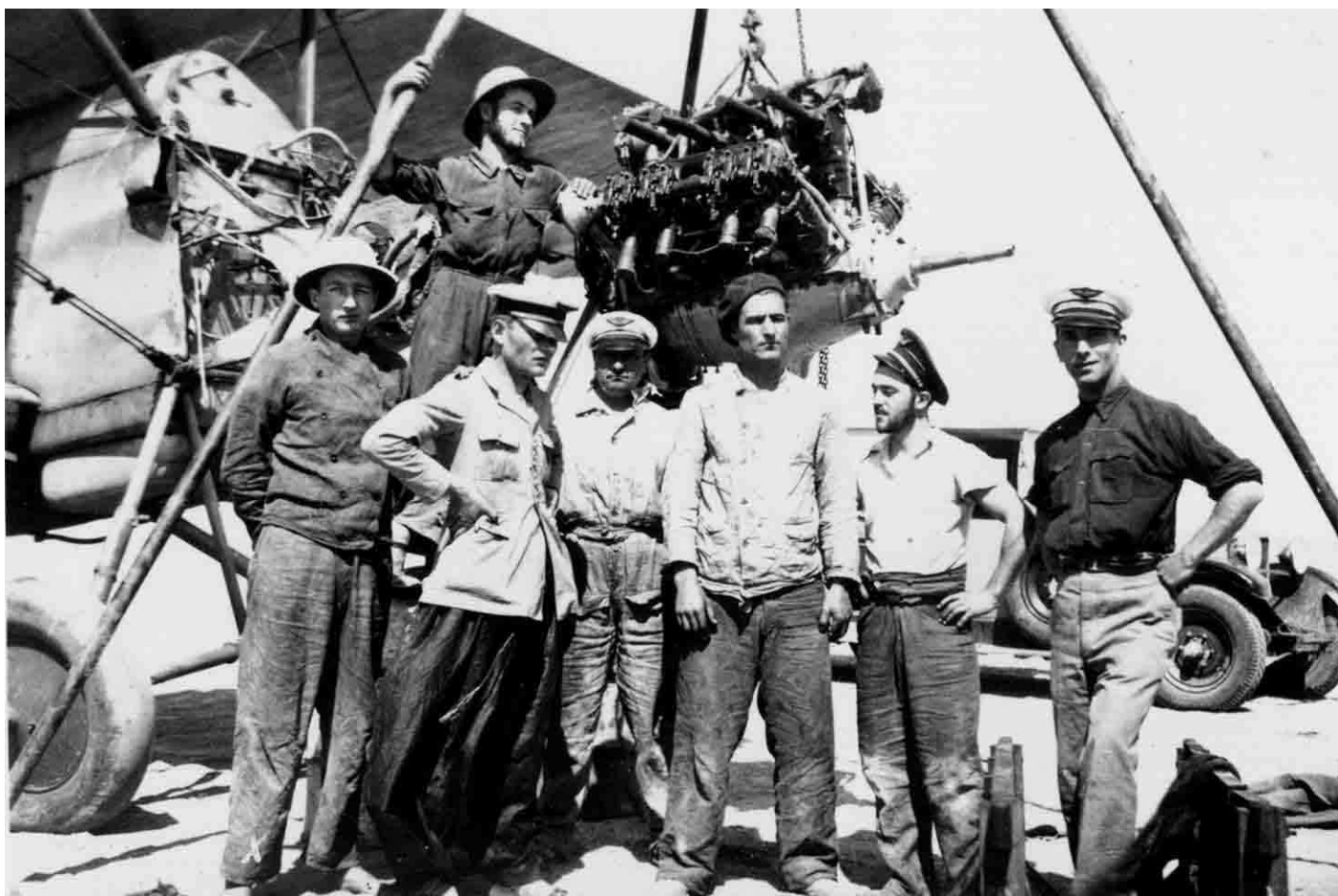
▲ Changement de moteur d'un Potez 25 à El-Goléa en 1935
