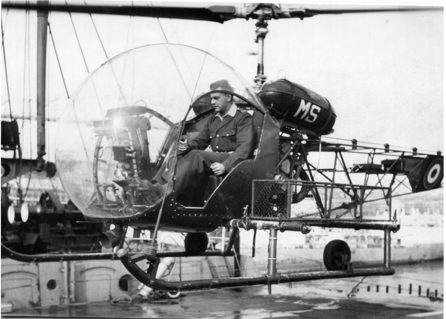
L'Agusta-Bell, codé MS, décolle du Léon-Mazella, dans le port d'Alger, fin décembre 1956. Aux commandes, le capitaine Durand. La cage grillagée sur le côté était destinée à recevoir des jerricans lors de la mise en place du peloton, puis les outils des mécanos et enfin, à Port Fouad, un légionnaire armé d'un FM (photo Michel Salmon)..
