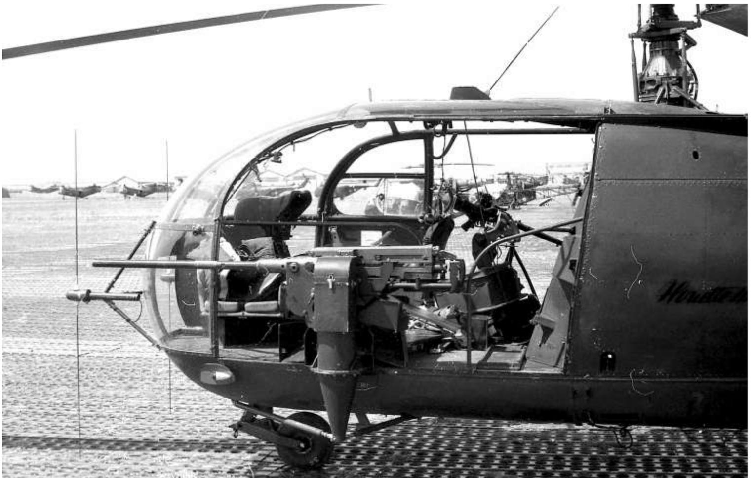
*Alouette III armée du canon Mauser MG 151, en expérimentation au sein du PMAH de la 19<sup>e</sup> DI (photo Pierre Lalanne).*
