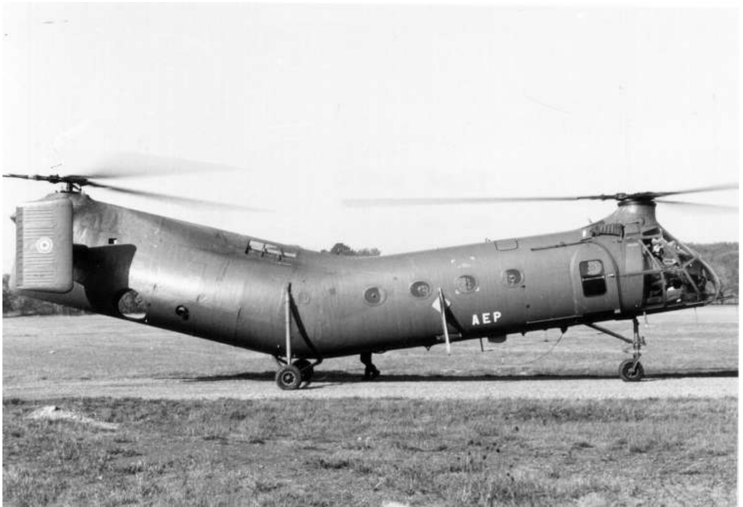
FR106/AEP du 40 e GALAT en 1968. Il est à noter que la machine porte la barre de maintien des SOA (la barre coudée entre le 3 e et le 4 e hublot, à gauche de l'immatriculation) qui était utilisée lors des parachutages en automatique. De même sur la Banane les parachutages s'effectuaient de la porte avant droite (photo X, collection Christian Malcros).
