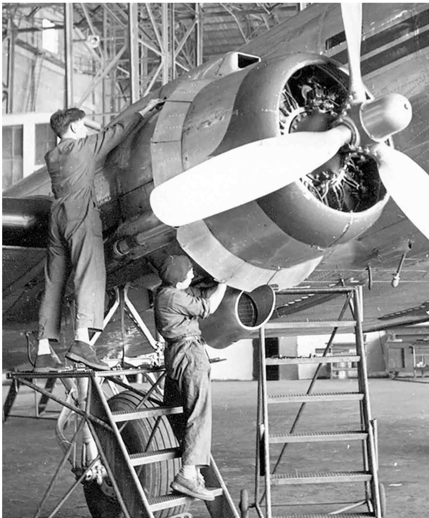
Yves Donius et Durdilly décapotent le moteur d'un DC 3 à Maison-Blanche en 1948.
