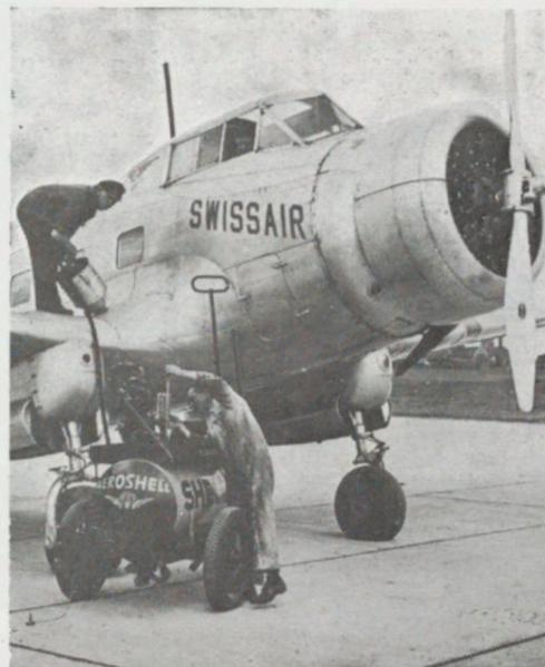
RAVITAILLEMENT, A MUNICH, DE L'AVION CLARK G. A. 43 A MOTEUR WRIGHT CYCLONE F. 1 DE 700 CV DE LA SWISSAIR
