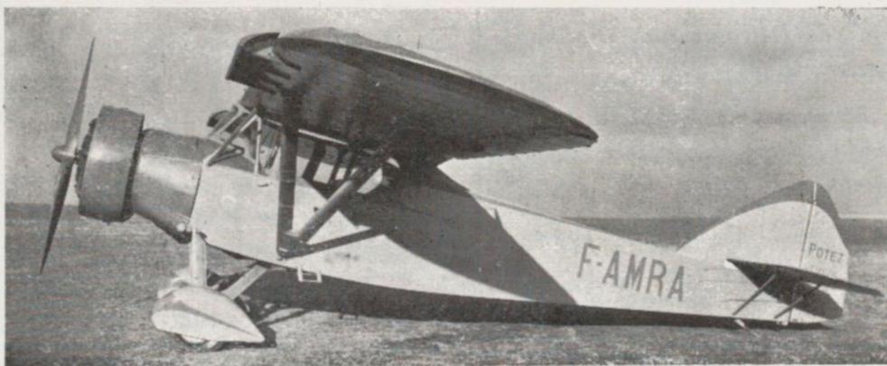
AVION POTEZ TYPE 58, MOTEUR POTEZ TYPE 6 B 120-140 CV.
