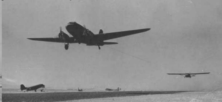
Planeur Waco CG-4 : 25,5 mètres d'envergure, 14,8 mètres de longueur, vitesse de remorquage : 241 km/h, vitesse de plané : 193 km/h, 15 hommes y compris le pilote, poids à vide : 1 678 kg, poids en charge : 4 082 Kg, 13 909 exemplaires construits. Nommé *Hadrian* dans la RAF.
