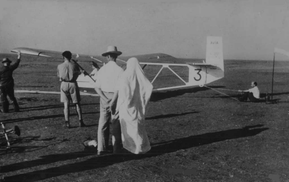
Sous des regards intéressés, l'Avia 152a est sur la glissière et un assistant le retient pendant la tension des sandows
