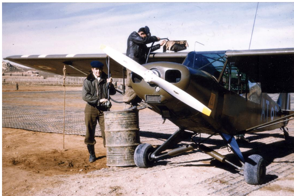
Piper L-21B (codé ATC) à l'avitaillement à Aflou, en 1958, l'insigne de la 4 e DIM peint sur le fuselage (photo Christian Anciaux).
