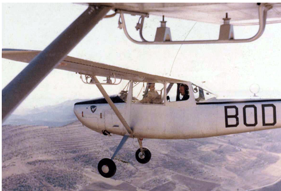
Cessna L-19E (codé BOD) avec l'insigne de la 20 e DI peint sur le capot moteur (photo Daniel Rougeau).
