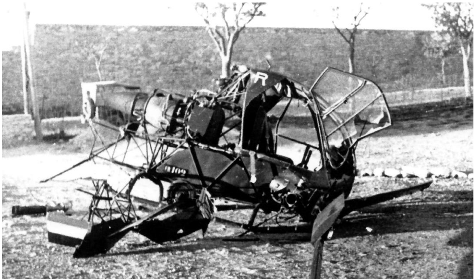
2° PMAH de la 13° DI, détachement du Telagh, le Djinn n°FR102/R est accidenté le 7 novembre 1959 d'un vol d'essai, Par suite d'une rupture du longeronnet de pale à son extrémité. L'aide mécanicien Rémi Laplace est grièvement blessé (photo Rémi Laplace, via Clément Charrut).
