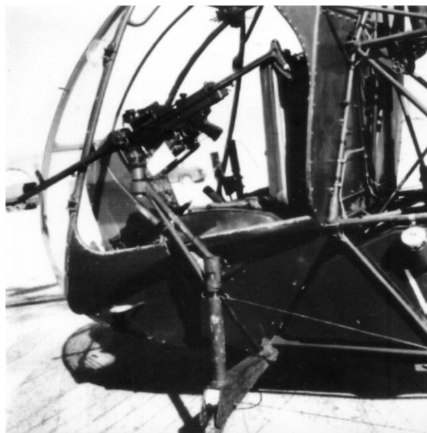
Des essais de tir de missiles SS-10 ont été réalisés à partir de Djinn (photo Sud-Aviation) Ainsi que l'équipement d'une mitrailleuse (photo Joseph Koberlé).
