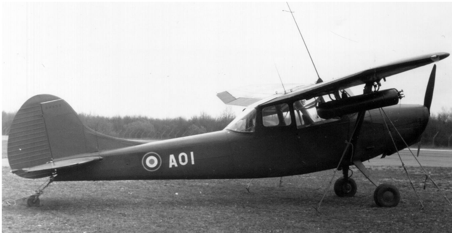
Cessna L-19E n° 24522/AOI en 1972 avec bidon d'épandage LCE 3400 sous l'aile, sur les supports Matra initialement prévus pour les lance-roquettes. Ce dispositif, adopté à partir de juin 1972, sert à simuler les attaques par des produits toxiques (photo W, collection Christian Malcros).
