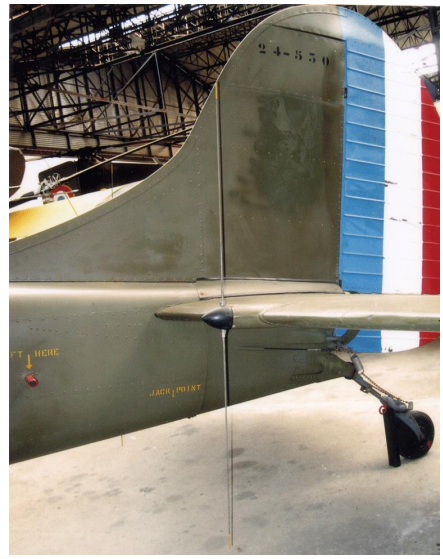
SB-327 ARC44 en place arrière et, à droite, antenne homing (photos Fred Descamps).
