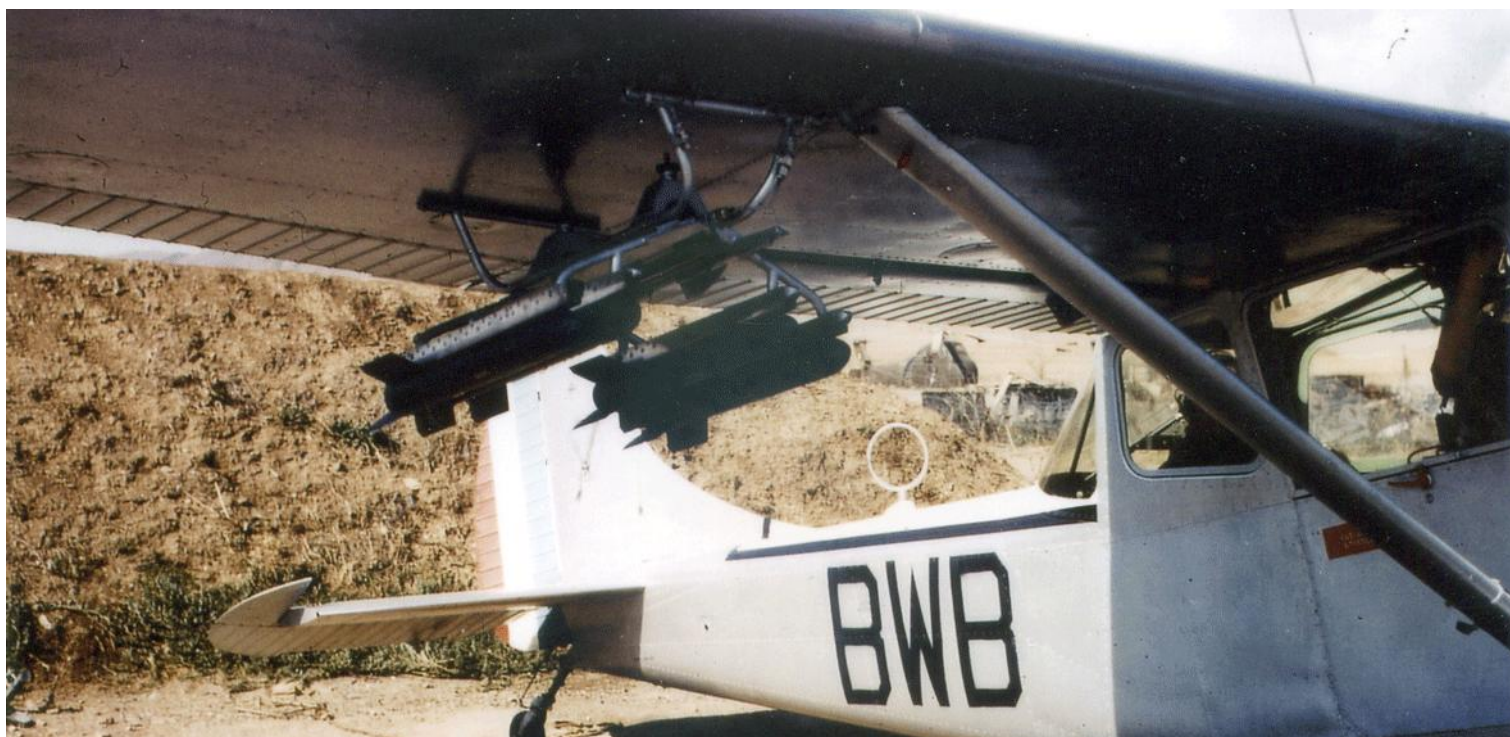
Lance-roquettes fumigènes Alkan-Matra sur Cessna L19E du PA de la 11 e DI, en 1961 (photo Jean Reymond).
