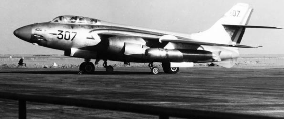
Vautour VIIN PP avec tuyère de prélèvement sous l'aile gauche
