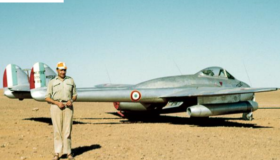
Mistral téléguidé, avec sa tuyère sous l'aile droite
