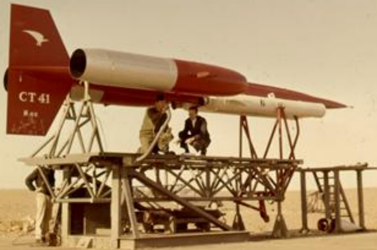
Engin cible hypersonique téléguidé Nord-Aviation CT 41 Narval équipé de deux fusées à poudre et de deux statoréacteurs
