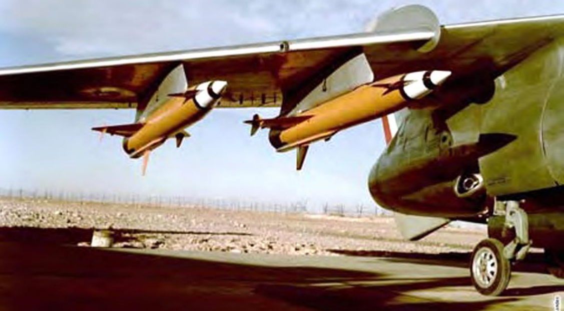
Missile air-air Matra R511, à guidage par radar, sous une aile de Vautour 2N du CEV
