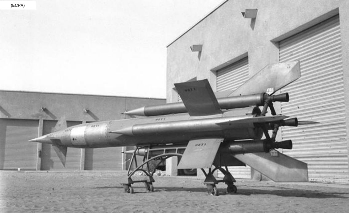
Missile antiaérien radioguidé à statoréacteur PARCA, en 1958
