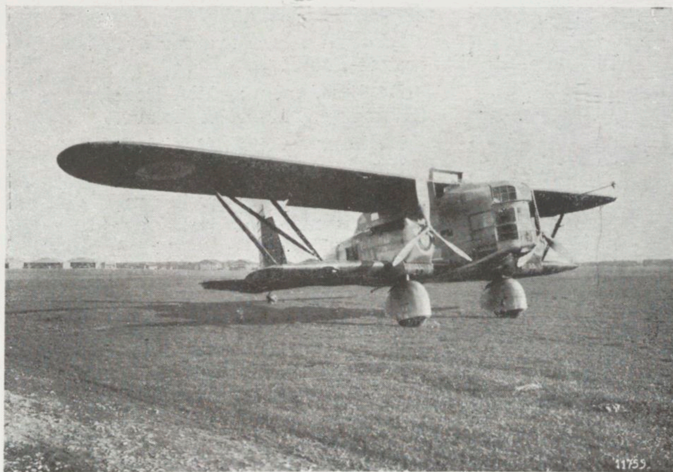
LE BRÉGUET 41 (BIMOTEUR HISPANO 650 CV), MULTIPLACE DE COMBAT.
