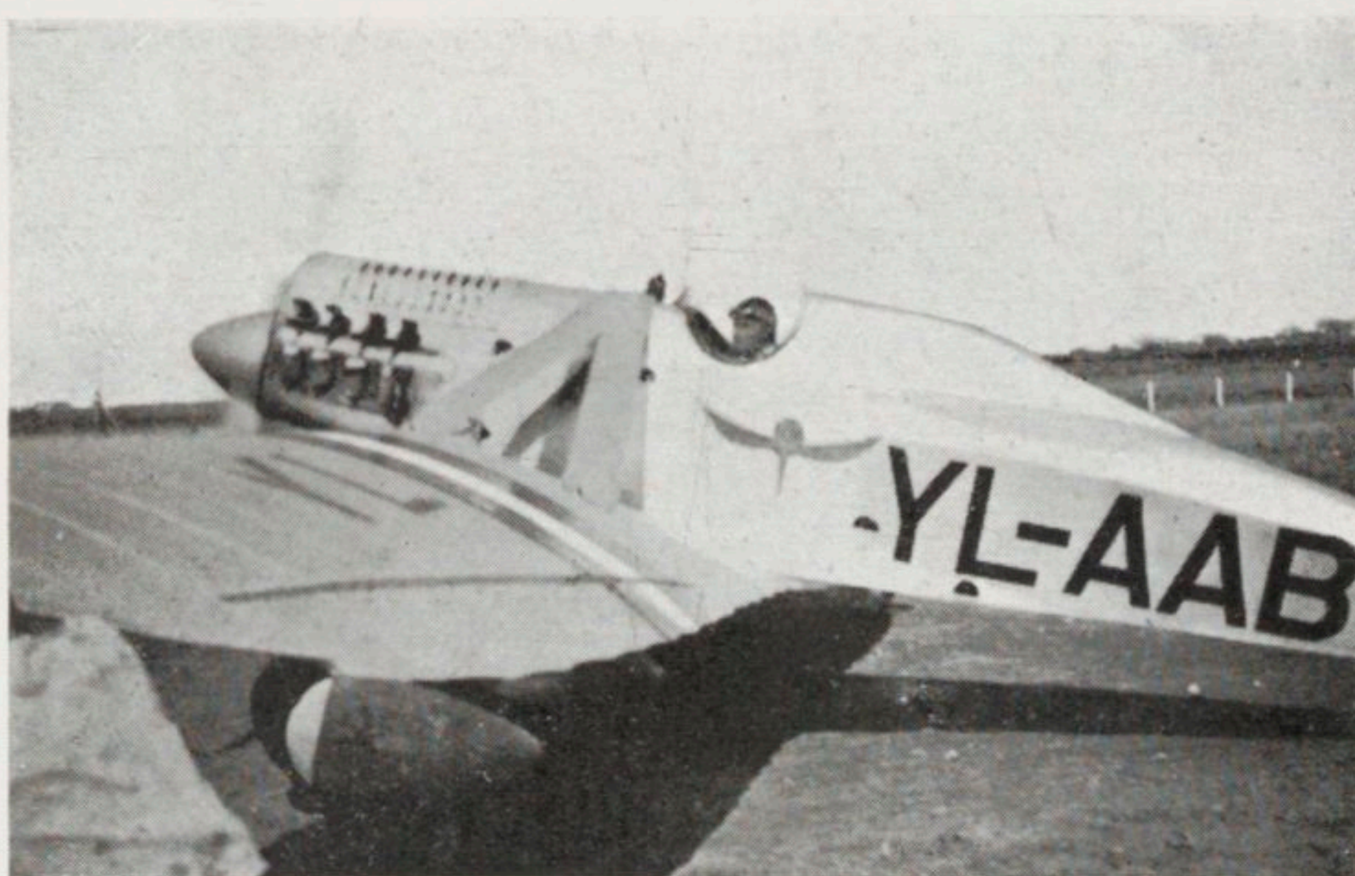
M. Cukurs aviateur letton qui vient d'effectuer sur cet avion de sa construction, le voyage Riga-Berlin-Paris-Barcelone-Casablanca-Dakar. Son avion est équipé d'un moteur Renault 80 CV type guerre.
