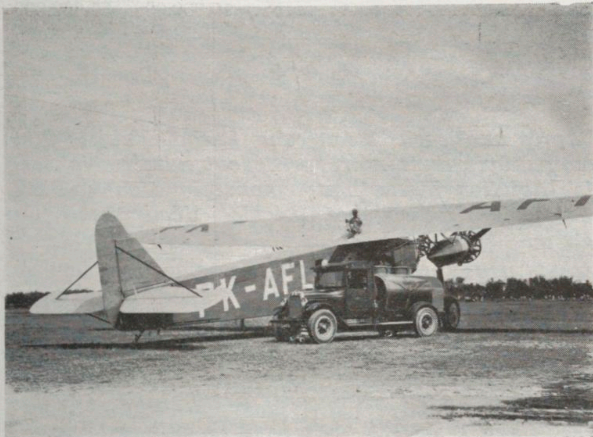
Ravitaillement par camion citerne Shell d'un Fokker FXII sur l'aérodrome de Tjepoe
