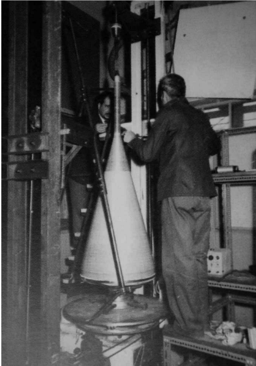
Fabrication d'un radôme de Mirage III sur une machine à bobiner
