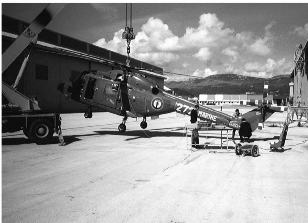
Pesée d'un Lynx permettant de déterminer sa masse et son centrage. Cette méthode est préconisée par le constructeur britannique Westland. Une pesée est nécessaire après la réalisation de travaux importants.
