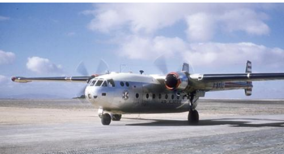
Les Nord 2502B, avec des réacteurs en bouts d'ailes, utilisés par Air Algérie pour le transport de personnel et de matériel
