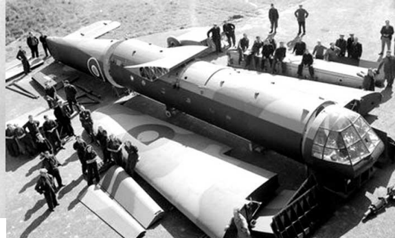
Le Horsa tel qu'il est livré pour remontage à l'AIA de Blida
