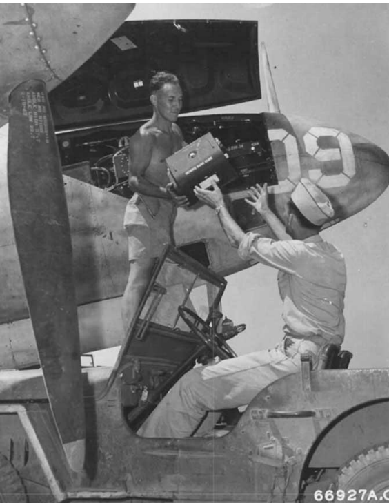
Récupération des appareils photos d'un F-5 et traitement des photos
