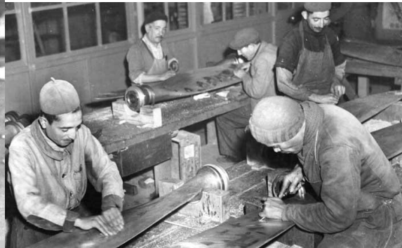
A Maison-Blanche, modification des empennages de Spitfire et atelier hélices ( IWM et USAF)
