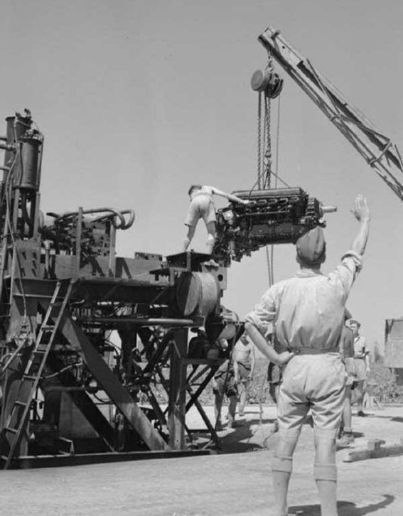
Banc d'essai moteurs et atelier moteurs à Maison-Blanche (IWM et USAF)
