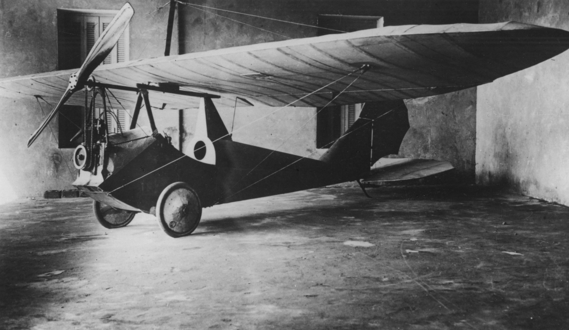
En 1933, à Rivoli, à côté de Mostaganem, le garagiste Roger Prietto construit, avec grand soin, un HM 8 équipé d'un moteur de moto Chase 500 cm 3 dont il tire difficilement 5 chevaux (pour un poids de 43 kg). L'ensemble pèse 130 kg en ordre de marche (Roger Prietto)
