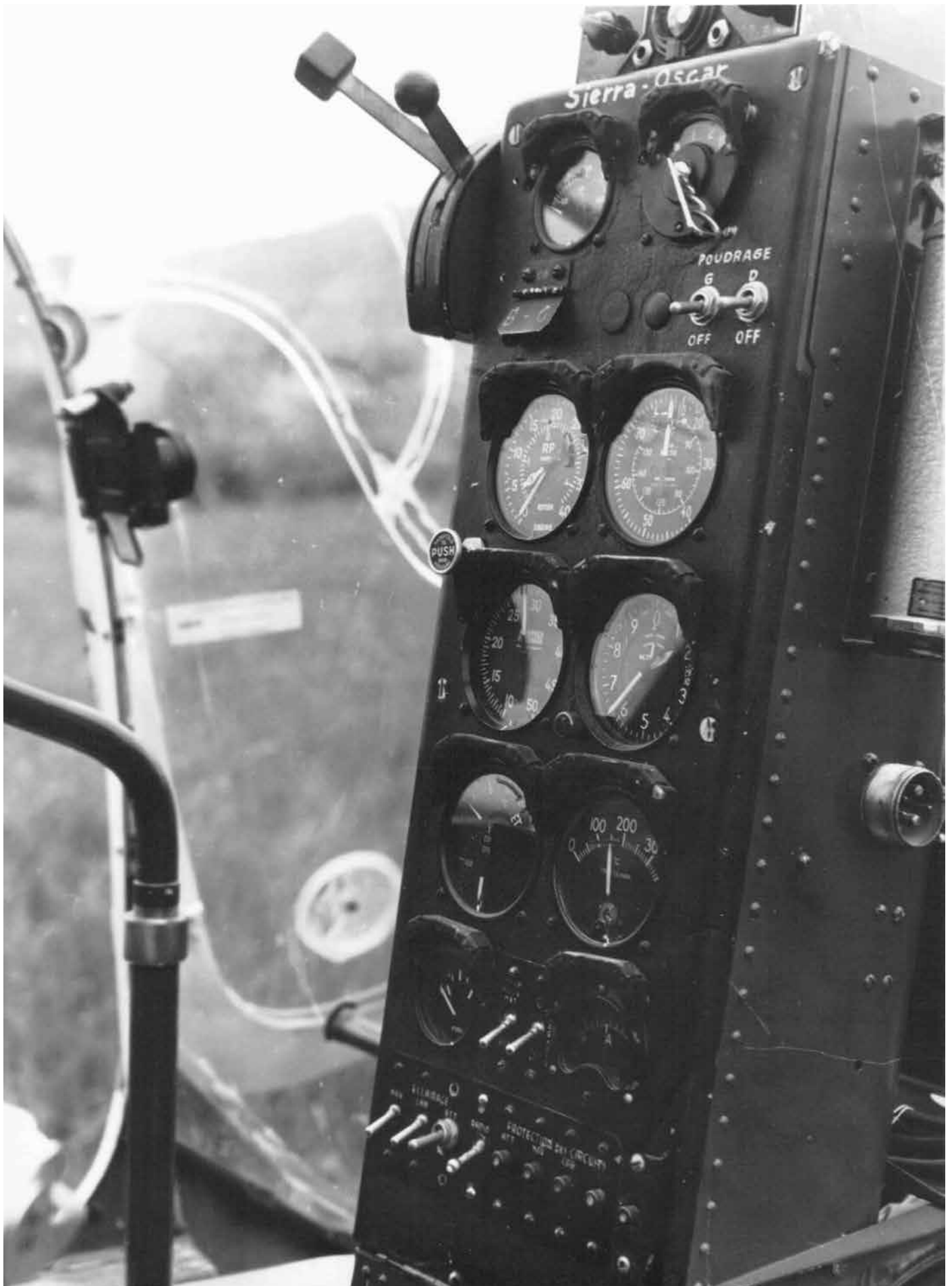
Le tableau de bord du Bell 47 F-OASO, remarquer les commandes de poudrage
