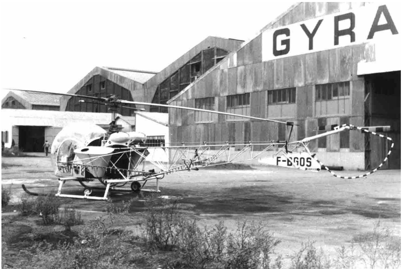
▲ Bell 47 à Maison-Blanche avec les rampes de poudrage. Gyrafrique a utilisé des Bell 47 G1 (moteur Franklin 6V4 de 200 ch) et des Bell 47 G2 (moteur Lycoming VO-435 de 260 ch)
